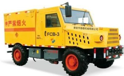
**FCB-3矿用爆破器材运输车**是本公司专为矿山井下运输爆破器材而研发制造的一种车辆，额定载重3000kg。货厢采用公安部备案，国内具有生产许可资质的企业制造的专用爆破器材箱。有报警器和密码锁，防止矿山非专业人士随意接触。选装国三排放发动机，环保节能，尾气处理安装三元催化器+水净化装置，减少巷道里面的空气污染。采用国内知名企业生产的变速箱和变矩器，无级变速，降低司机劳动强度。减震座椅，舒适度高。制动系统采用专业液压制动系统，行车制动和驻车制动均采用全封闭湿式液压制动器，灵敏可靠。整车抗碰撞、抗冲击，操控方便，使用寿命长。离地间隙不低于280mm，通过性好。该车已通过国家矿用产品安全标志认证!
