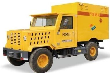
**FCB-1.5矿用井下爆破器材运输车**是鲁瞻机械严格按照国家标准GB 21500—2008; Q/GAT 10—2019自行设计、制造的一款专门服务非煤矿山井下运输爆破器材的箱式柴油运输车。产品选用新柴国三排放的4D27G31型发动机，功率50马力。本型柴油机噪音低，排放好，扭矩大，功率储备大。采用弹簧制动液压释放湿式制动桥，四轮驱动，通过性好;高低速机械变速箱，变速幅度大，低速驱动力大、操作简便;维护简单。由公安部授权检测通过的专业生产厂家制造的器材运输厢，安全性强，可靠性高。双驾乘人员设计，有效解决押运员随车问题。空气减震+弹簧板组合方式，解决了驾乘舒适度问题，也适应了车辆自重大的问题。贵金属催化装置双重发动机尾气处理，有效降低排放，有效防护驾驶员安全;选装空调;软包内饰，降噪美观。
