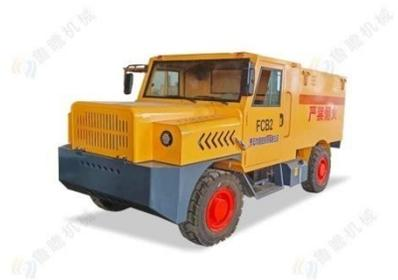
**FCB-2矿用爆破器材运输车**是本公司专为矿山井下运输爆破器材而研发制造的一种车辆，额定载重2000kg。货厢采用公安部备案，国内具有生产许可资质的企业制造的专用爆破器材箱。有报警器和密码锁，防止矿山非专业人士随意接触。产品选装国三排放发动机，环保节能，尾气处理安装三元催化器+水净化装置，减少巷道里面的空气污染。采用国内知名企业生产的变速箱和变矩器，无级变速，降低司机劳动强度。减震座椅，舒适度高。制动系统采用专业液压制动系统，行车制动和驻车制动均采用全封闭湿式液压制动器，灵敏可靠。整车抗碰撞、抗冲击，操控方便，使用寿命长。离地间隙不低于180mm，通过性好。该车已通过国家矿用产品安全标志认证!
